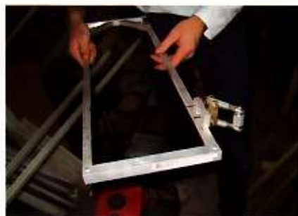
Frame voor de New Beetle, met ophanging voor een van de wielen
